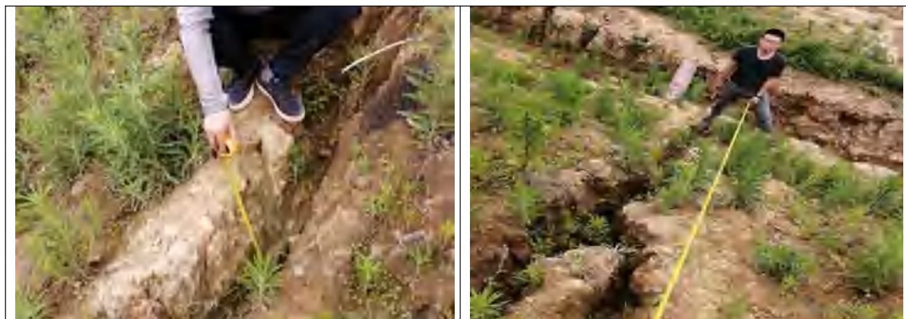
侵蚀沟量测法获取水土流失基础数据（水库主体工程）
